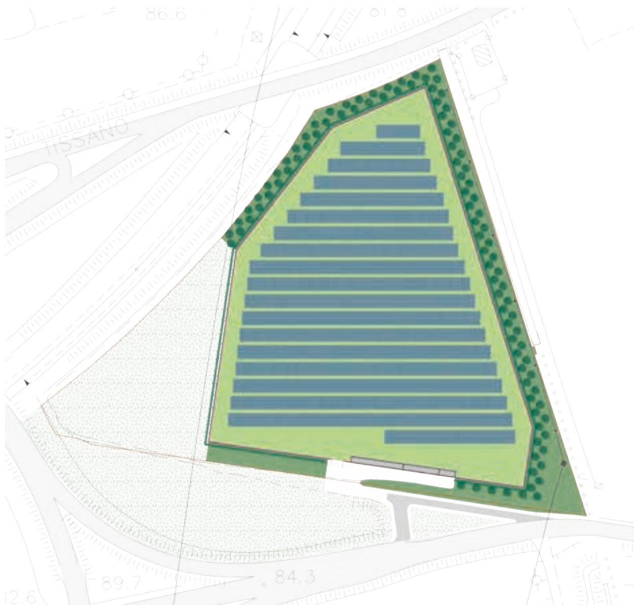
Fig. 58 - Rappresentazione layout dell'impianto e superfici di mitigazione annesse. Da: Tavola di progetto PDCIV01.
