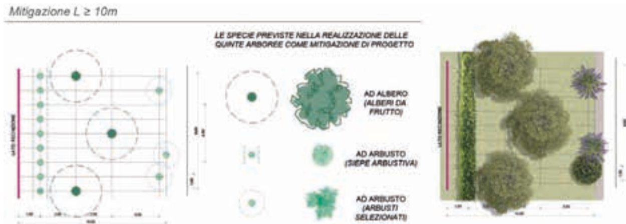
Fig. 62 - Fascia di mitigazione strutturata come quinta verde e predisposta alla produzione agricola integrata.
